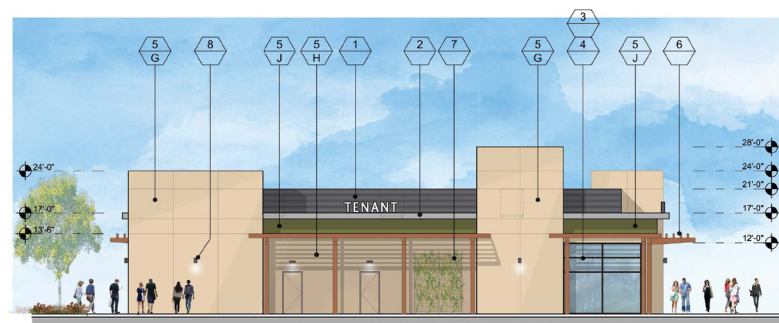
① NORTH ELEVATION SCALE: 1/8" = 1'-0"
