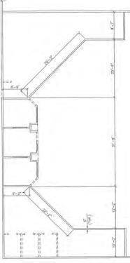
PARTIAL REFLECTED CEILING DETAIL N.T.S. CEILING GRID LAYOUT ARE FOR REPRESENTATION PURPOSES ONLY.
