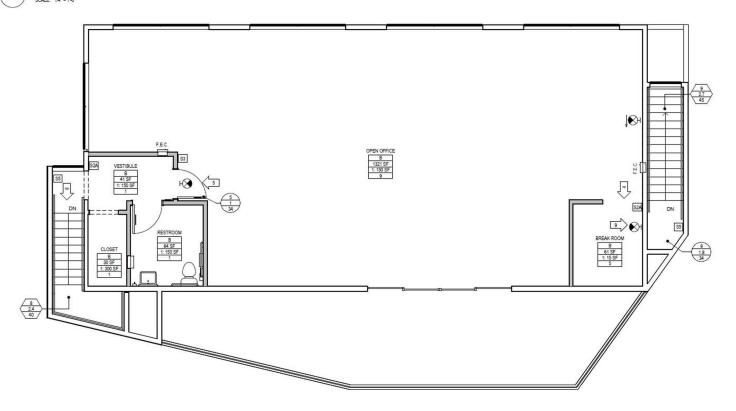
SECOND LEVEL CODE AND OCCUPANT EXITING PLAN
